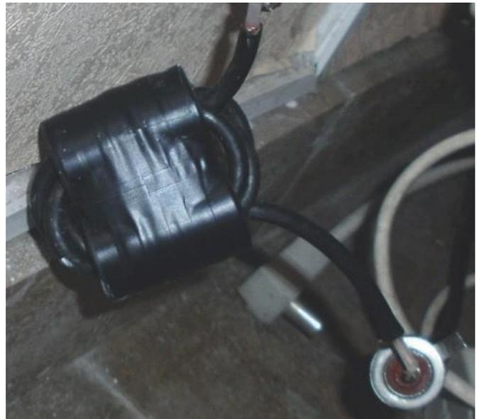
*Le coaxial est enroulé sur deux piles de tores formant deux tubes. Le principe de ce système permet de n'avoir qu'un petit nombre de spires pour obtenir une forte impédance.*
