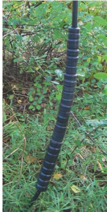
*Un empilement de tores et de tubes en ferrite sur une longueur de 30cm. Les tores du haut (côté antenne) sont ceux qui ont la plus faible perméabilité pour limiter les pertes sur les bandes hautes. En effet, ce choke-balun doit renvoyer la HF vers l'antenne ou la rayonner sans rien perdre.*
